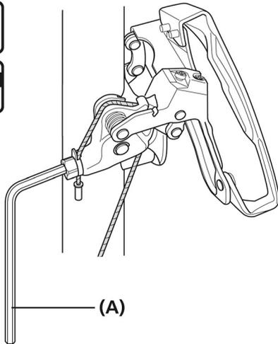
(A) Шестигранный ключ на 5 мм/гаечный ключ на 9 мм
