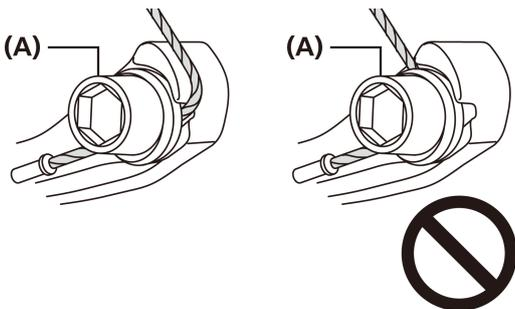
(A) Крепежный болт провода
