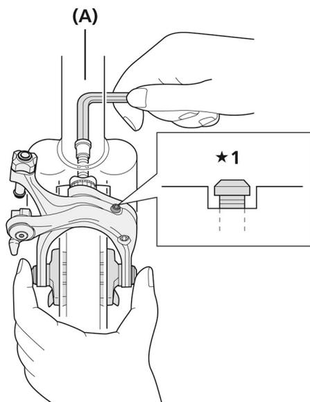
★1 Нормальное положение головки центрирующего регулировочного болта при установке показано на рисунке.
