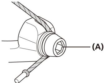
(A) Крепежный болт провода
