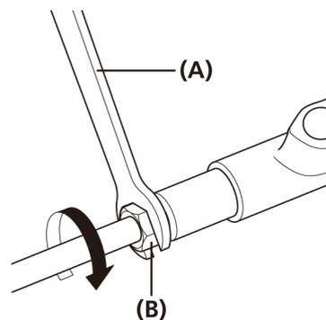
(A) Гаечный ключ на 8мм
