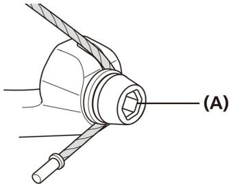
(A) Крепежный болт провода
