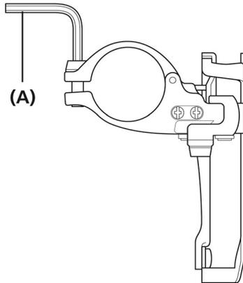
(A) Шестигранный ключ на 5 мм или гаечный ключ на 9 мм
