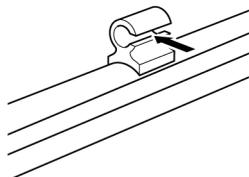
Обычный тип фиксатора тросика
