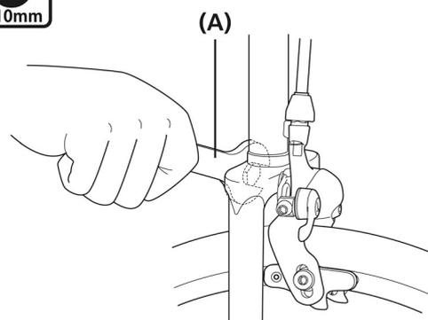
(A) Гаечный ключ на 10мм
