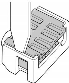
3. Вставьте кабель с маркировкой в заземленную сторону коннектора.
