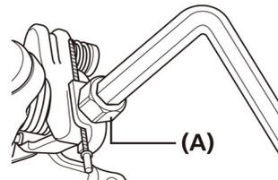
(A) Крепежный болт провода
