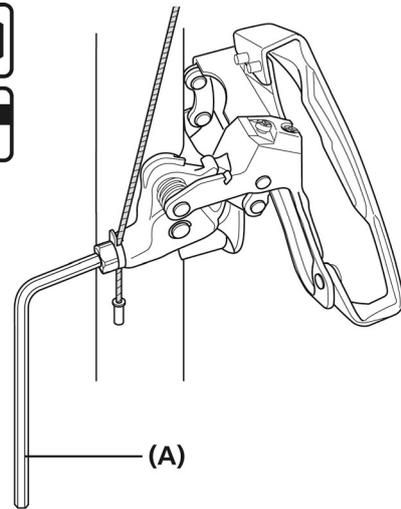
(A) Шестигранный ключ на 5 мм/гаечный ключ на 9 мм
