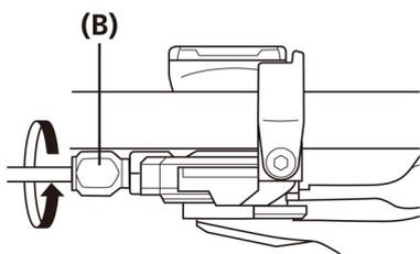
(A) Винт регулировки натяжения троса
