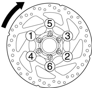
3. Используйте плоскую отвертку или подобный инструмент, чтобы загнуть концы стопорной пластины вокруг головок болтов.
