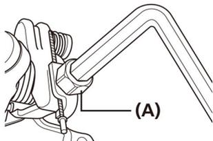
(A) Крепежный болт провода
