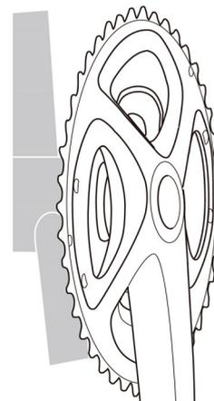
3. Установите секцию с широким пазом левого шатуна на ось узла правого шатуна, где паз широкий.
