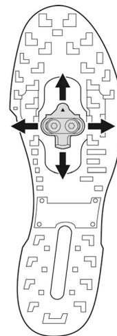
2. После того как вы определили оптимальное положение шипа, надежно затяните крепежные болты шипа шестигранным ключом на 4 мм.
