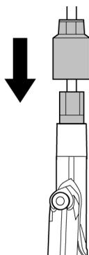
9. Снимите стопор тормозной ручки
