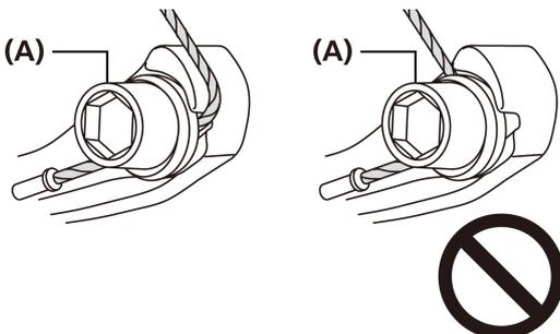
(A) Крепежный болт провода
