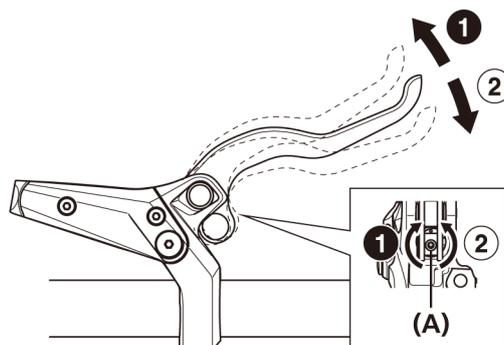
(A) Винт регулировки досягаемости
